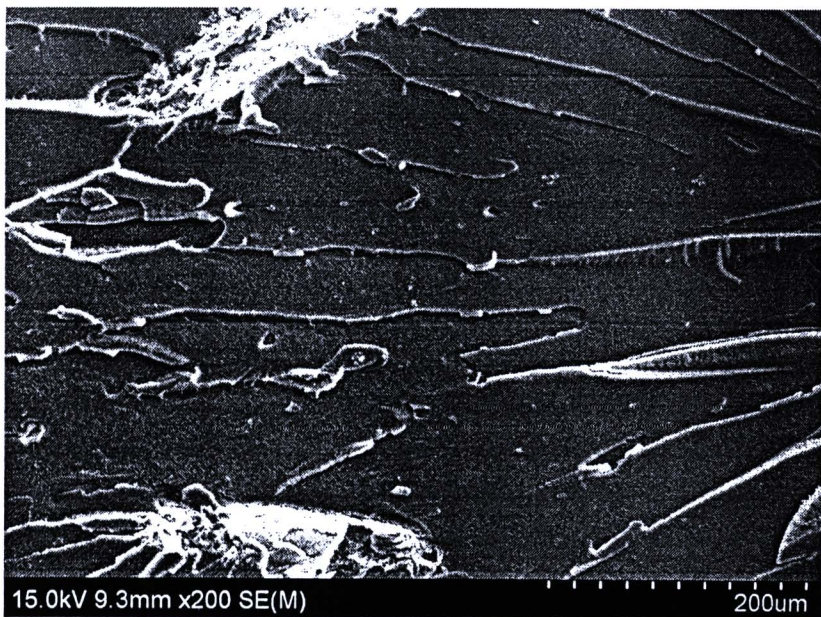
ค-12 ลักษณะสัณฐานวิทยาของชิ้นงานทดสอบอีพ็อกซีเรซินใหม่ผสมรีไซเคิลเรซิน อัตราส่วนผสม ร้อยละ 20 จากกล้องจุลทรรศน์อิเล็กตรอนแบบส่องกราด กำลังขยาย 200 เท่า
