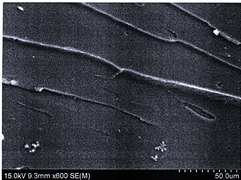
ค-13 ลักษณะสัณฐานวิทยาของชิ้นงานทดสอบอีพ็อกซีเรซินใหม่ผสมรีไซเคิลเรซิน อัตราส่วนผสม ร้อยละ 20 จากกล้องจุลทรรศน์อิเล็กตรอนแบบส่องกราด กำลังขยาย 600 เท่า
