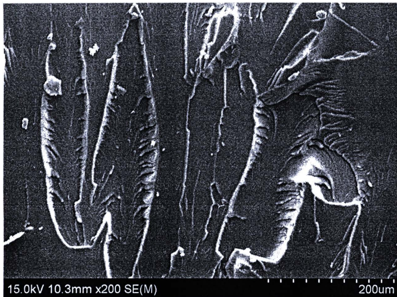
ค-3 ลักษณะสัณฐานวิทยาของชิ้นงานทดสอบอีพ็อกซีเรซินจากกัลีองจุลทรรศน์อิเล็กตรอนแบบ ส่องกราด กำลังขยาย 200 เท่า
