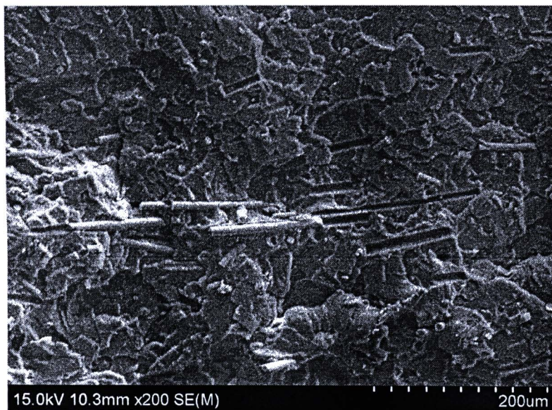
ค-19 ลักษณะสัณฐานวิทยาของชิ้นงานทดสอบอีพ็อกซีเรซินใหม่ผสมผงวงจรีเล็กทรอนิกส์บัด ขนาด 160-200 mesh อัตราส่วนผสมร้อยละ 10 จากกล้องจุลทรรศน์อิเล็กตรอนแบบส่องกราด กำลังขยาย 200 เท่า
