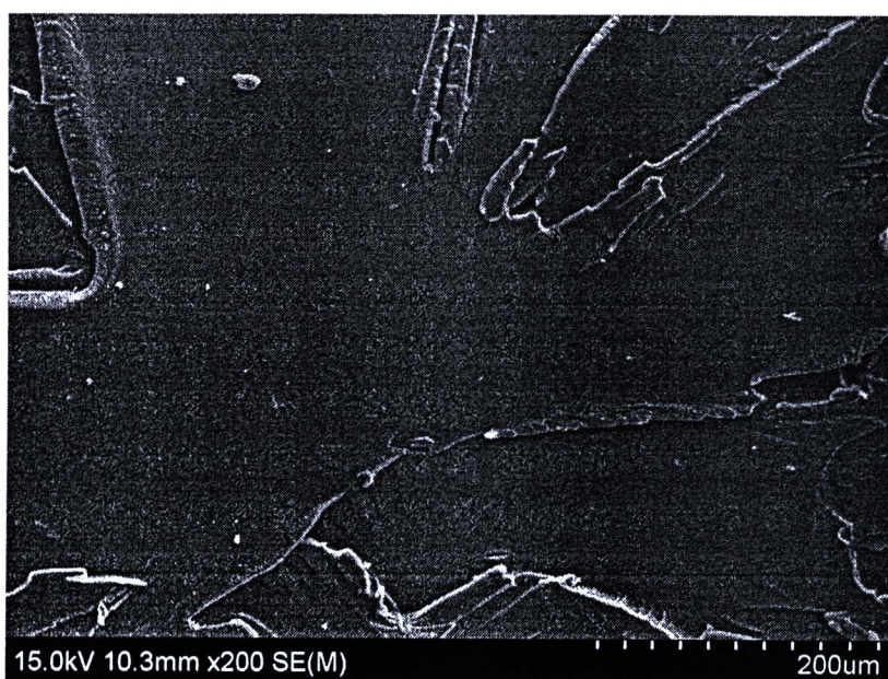
ค-2 ลักษณะสัณฐานวิทยาของชิ้นงานทดสอบอีพ็อกซีเรซินจากกัลลิ่งจุลทรรศน์อิเล็กตรอนแบบ ส่องกราด กำลังขยาย 200 เท่า
