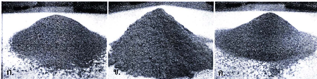
ภาพที่ 3-3 แผงวอร์อิเล็คทรอนิกส์ ก. ขนาดอนุภาค 60-80 mesh ข. ขนาดอนุภาค 80-160 mesh ค. ขนาดอนุภาค 160-200 mesh
