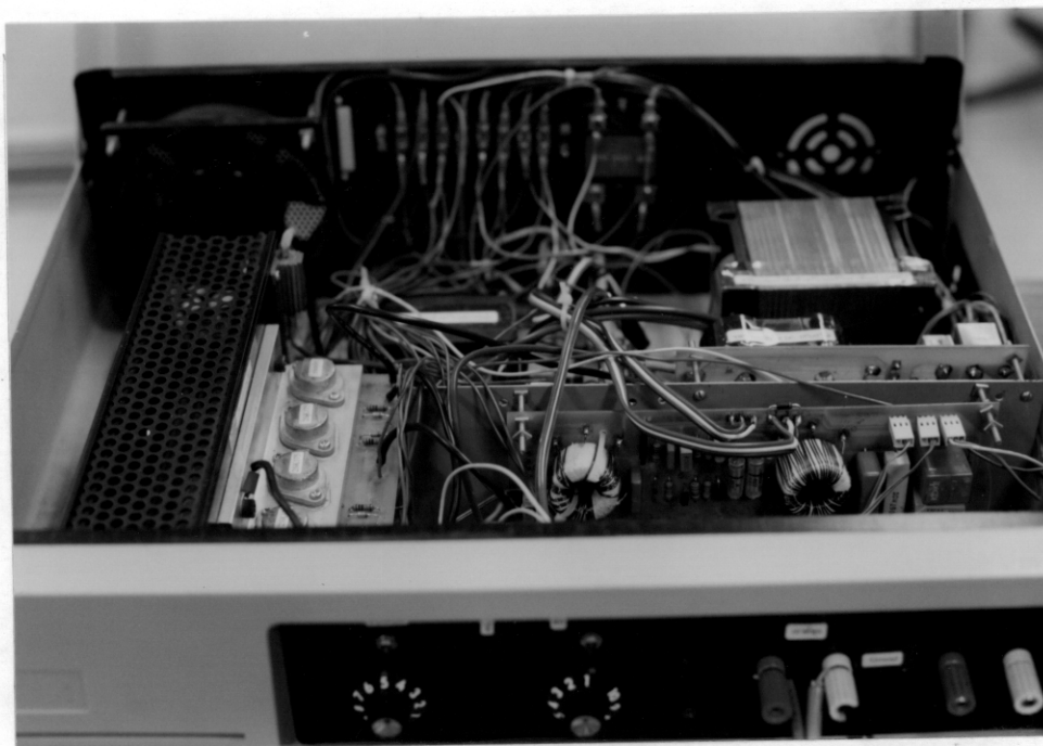
รูปที่ 4.6 แสดงภาพการวางอุปกรณ์ทั้งหมดภายในเครื่องต้นแบบมุมมองด้านหน้า
