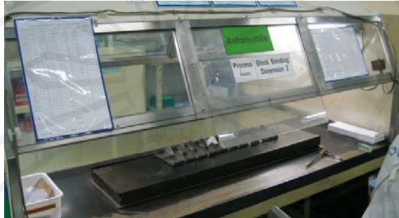
รูป 4.9 แสดงเตาความร้อนสำหรับยึดแผ่นเวเฟอร์ที่ผ่านการขัดผิวแล้ว
