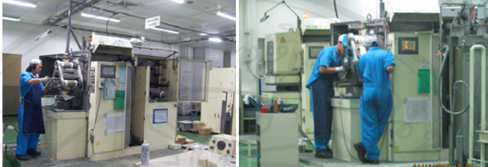
รูป 4.33 แสดงการร้อยเส้นลวดตัดแผ่นเวเฟอร์ตามร่องลือเครื่องตัด
