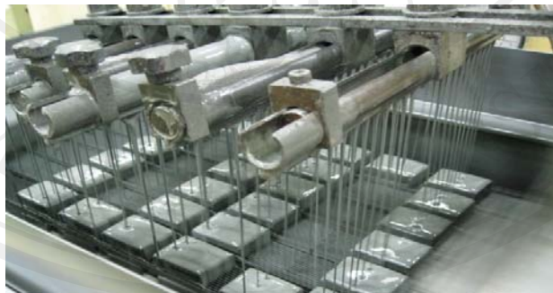
รูป 4.10 แสดงการตัดแผ่นเวเฟอร์ด้วยใบมีด
