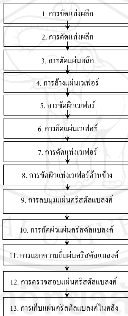
รูป 4.3 แสดงแผนผังกระบวนการผลิตแผ่นคริสตัลแบบลงค์
