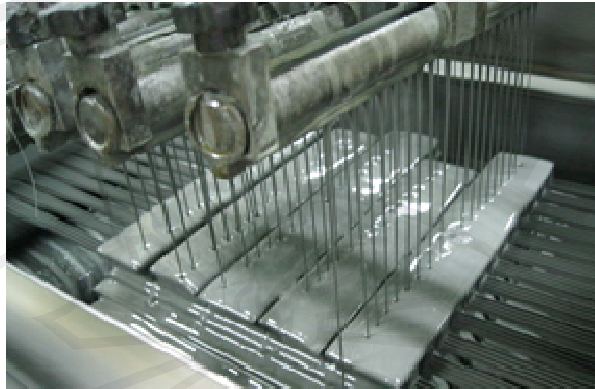
รูป 4.41 แสดงการตัดแท่งเวเฟอร์ด้วยเครื่องตัดแบบใบมีด
