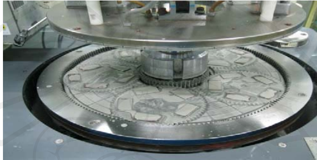
รูป 4.11 แสดงการขัดผิวแผ่นเวเฟอร์ด้านข้าง
