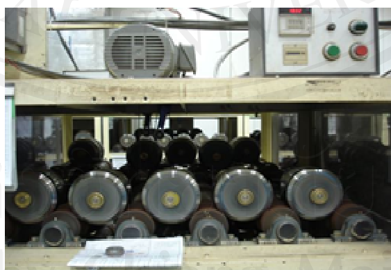
รูป 4.44 แสดงการลบมุมแผ่นเวเฟอร์ด้วยเครื่องลบมุม
