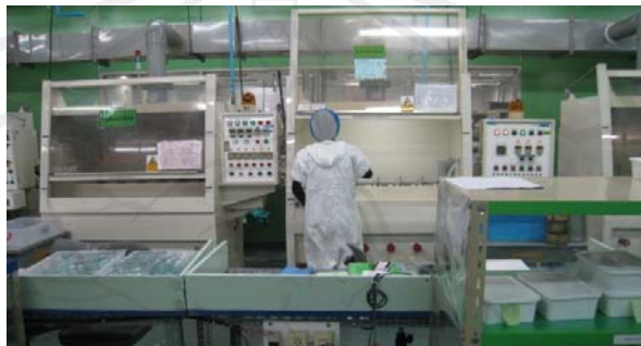
รูป 4.13 แสดงเครื่องกัดผิวแผ่นคริสตัลแบบลงค์ด้วยสารเคมี
