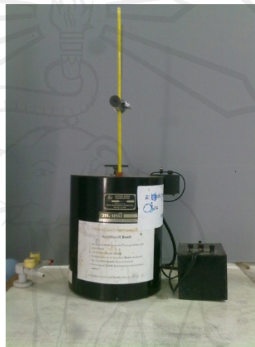
รูป 2.6 เครื่องวิเคราะห์ค่าความร้อน (Bomb calorimeter)
