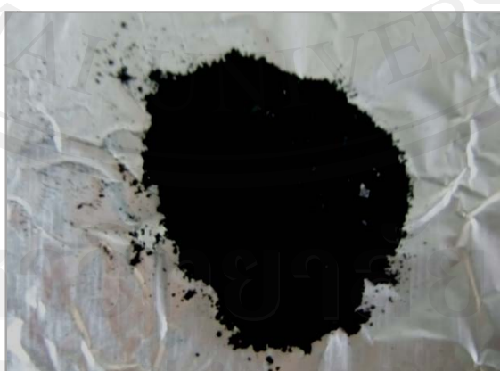
รูป 3.2 ผงท่อนาโนคาร์บอนที่ผ่านการทรีทเมนต์ด้วยการเผาที่อุณหภูมิ 430\text{ }^{\circ}\text{C} เป็นเวลา 4 ชั่วโมง
