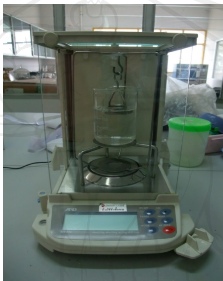
รูป 3.11 ชุดอุปกรณ์ในการหาความหนาแน่นของวัสดุผสม
