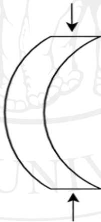
รูป 2.16 การเสียรูปแบบโค้งงอออกด้านข้างของวัสดุภายใต้แรงอัด [32]
