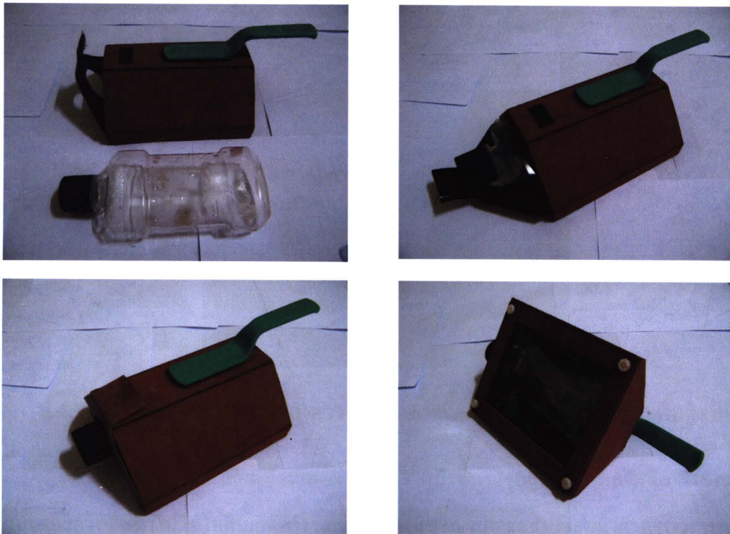
รูป 4.1 อุปกรณ์ต้นแบบสำหรับตรวจหารอยลายนิ้วมือแฝงโดยใช้ไอโอดีน
