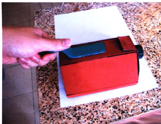
รูป 4.3 ลักษณะของการกวาดเครื่องตรวจหารอยลายนิ้วมือแฝงที่สร้างขึ้นไปบนพื้นผิววัตถุ
