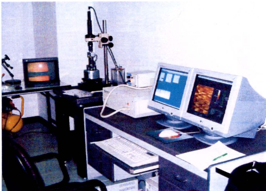
รูป 3.6 กล้องจุลทรรศน์แรงอะตอม (AFM) Veeco Digital Instruments รุ่น Nano Scope ® IIIa
