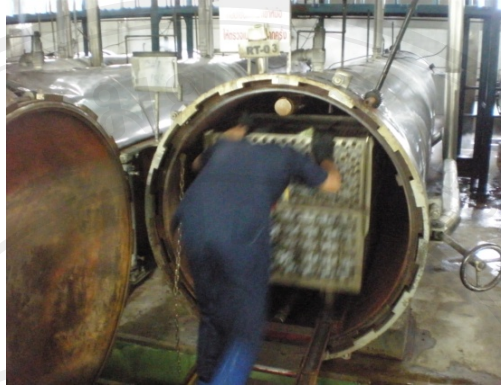
ภาพที่ 2-8 การจัดเรียง ขก/ เคลื่อนย้ายปลากะป๋องในขั้นตอนการนึ่งฆ่าเชื้อ
