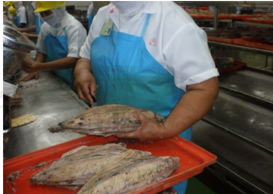
ภาพที่ 2-5 การทำความสะอาดโดยการขูดหนังและขูดแยกเลือดปลา
