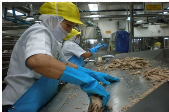
ภาพที่ 2-6 การเรียงเนื้อปลาเข้าสู่รางเครื่องสับปลาเพื่อบรรจุกระป๋อง
