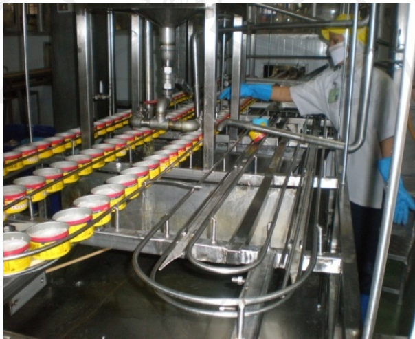
ภาพที่ 2-7 การลำเลียงกระป๋องที่ผ่านการบรรจุเข้าเครื่องปิดผนึกฝากระป๋อง
