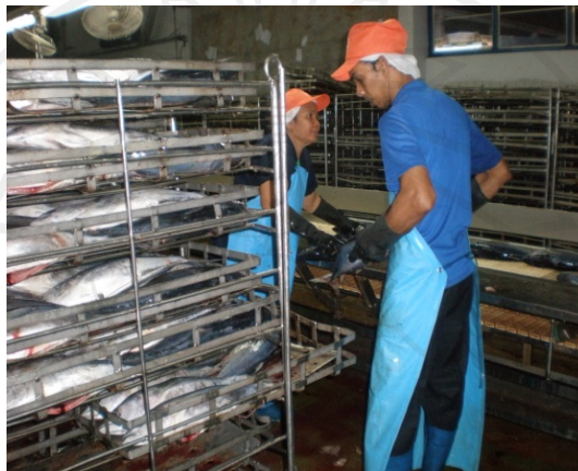
ภาพที่ 2-4 การยกตะแกรงบรรจุปลาขึ้นรถเข็น เคลื่อนย้ายเข้าสู่หม้ออบไอน้ำ
