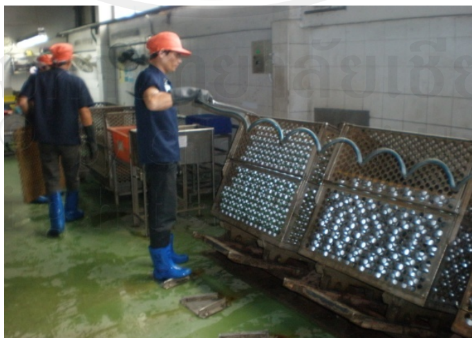
ภาพที่ 2-9 การเป่าแห้งด้วยเครื่องเป่าลมแรงดันสูงเพื่อป้องกันการเกิดสนิมของกะป๋อง
