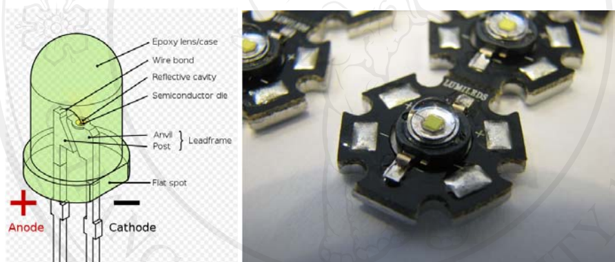
รูป 1.3 แสดงหลักการทำงานของหลอดไฟแอลอีดี
