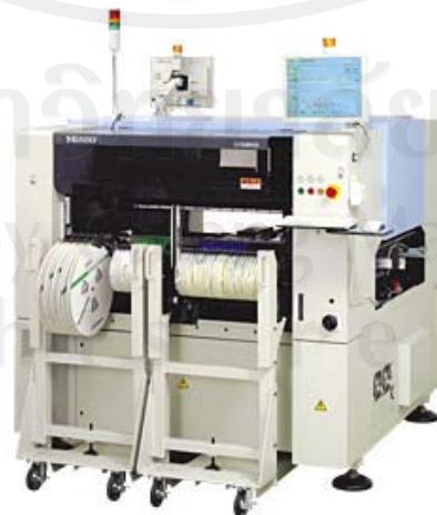
รูป 3-1 เครื่องประกอบชิ้นส่วนอิเล็กทรอนิกส์ ยี่ห้อ YAMAHA รุ่น YG100
