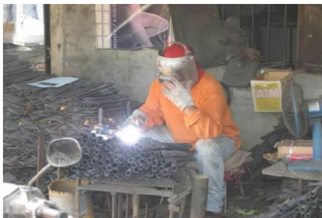
รูปที่ 4.5 การเชื่อมด้ามมีดพรวดด้วยลวดเชื่อมไฟฟ้า
