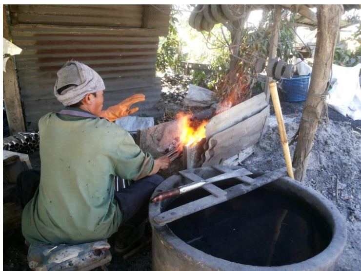
รูปที่ 4.8 การชุบแข็งมีดด้วยน้ำ
