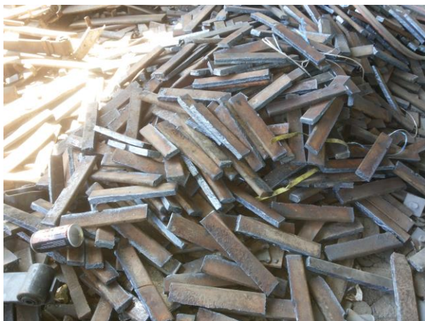
รูปที่ 4.2 การตัดเหล็กแนบรถยนต์เก่าตามขนาดก่อนตีขึ้นรูป
