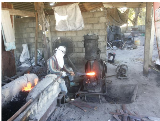
รูปที่ 4.4 การตีขึ้นรูปมีดพรวดด้วยเครื่องกระทบ
