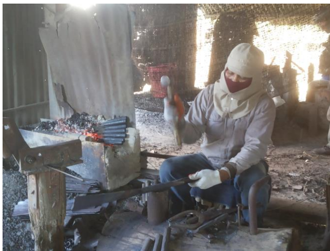
รูปที่ 4.6 การล่ำเรียบหรือย่ำดัดเพื่อให้มีได้รูปทรงที่ต้องการ
