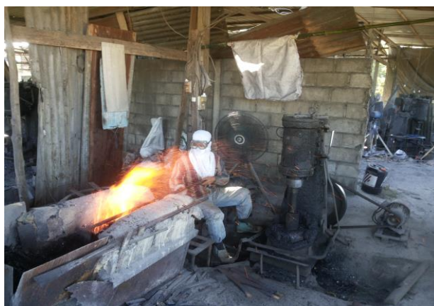
รูปที่ 4.3 การเผาเหล็กแนบด้วยเตาเชื้อเพลิงถ่านไม้
