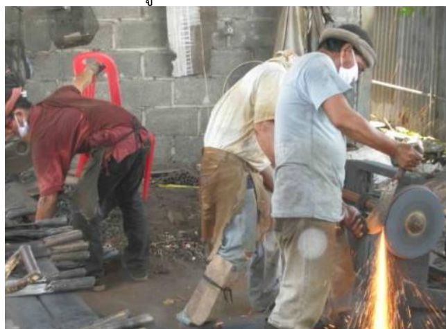
รูปที่ 4.7 การเจียรนัยมีดเพื่อให้มีความคมและผิวมันเงา
