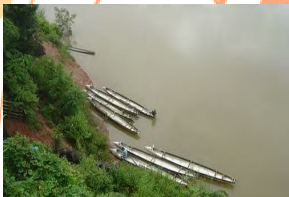
ภาพที่ 7.18 เรือจากถ้ำน้ำมันของเรือบิน B52 ที่ทหารอเมริกันทิ้งเป็นขยะลงมา ชาวลาวจึงใช้ภูมิปัญญาท้องถิ่นประยุกต์ดัดแปลงมาเป็นเรือใช้ในปัจจุบัน
