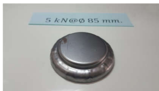
ภาพที่ 4.11(ง) แผ่นชิ้นงานเปล่า 85 มิลลิเมตร แรงจับยึด 5 kN
