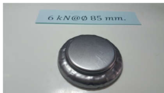
ภาพที่ 4.11(จ) แผ่นชิ้นงานเปล่า 85 มิลลิเมตร แรงจับยึด 6 kN
