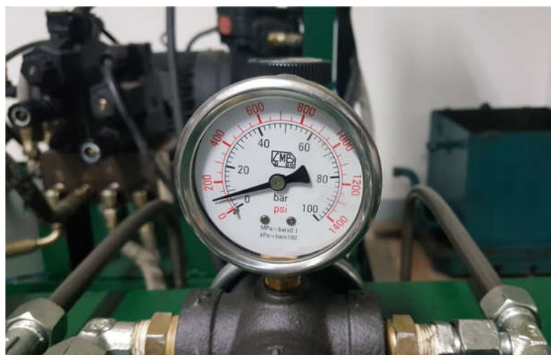
ภาพที่ 4.10 วาล์วปรับความดันในการจับยึดชิ้นงานและมาตรวัดความดันของเครื่อง
