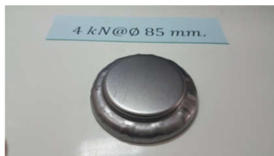
ภาพที่ 4.11(ค) แผ่นชิ้นงานเปล่า 85 มิลลิเมตร แรงจับยึด 4 kN
