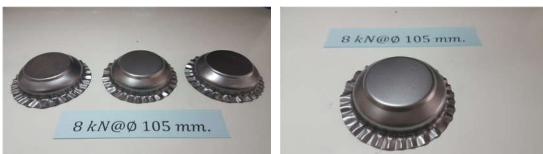
ภาพที่ 4.15(ข) แผ่นชิ้นงานเปล่า 105 มิลลิเมตร แรงจับยึด 8 kN
