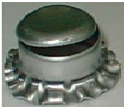
ภาพที่ 2.6 การฉีกขาดที่ก้นถ้วยบริเวณเหนือรัศมีพันซ์
