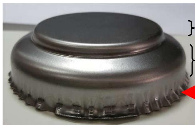
ภาพที่ 4.17(ค) ชิ้นงานที่ขนาดแผ่นขึ้นงานเปล่า 95 มิลลิเมตร แรงจับยึด 6 kN
