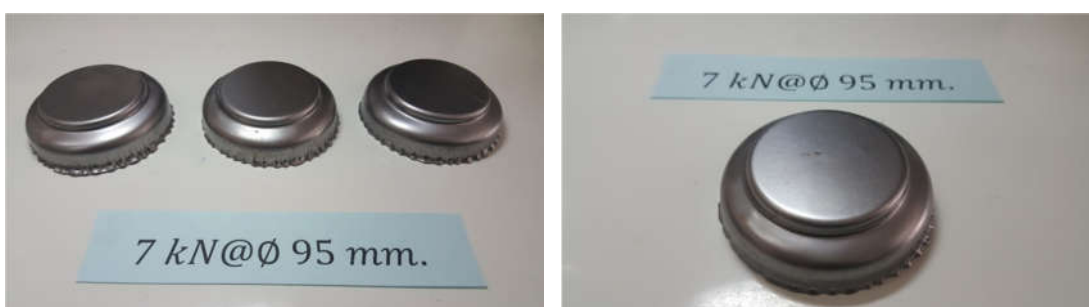
ภาพที่ 4.13(ง) แผ่นชิ้นงานเปล่า 95 มิลลิเมตร แรงจับยึด 7 kN
