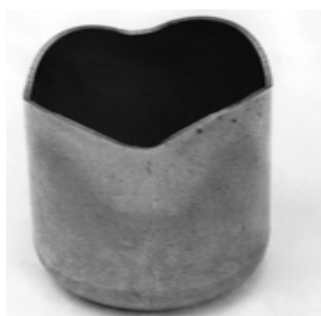
ภาพที่ 2.8 การเกิดเอียร์ริงของชิ้นงาน
