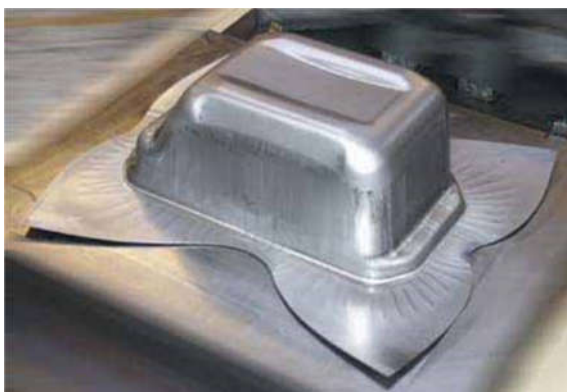
ภาพที่ 2.9 รอยขีดถูบนผนังถ้วย
