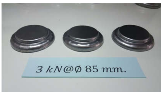
ภาพที่ 4.11(ข) แผ่นชิ้นงานเปล่า 85 มิลลิเมตร แรงจับยึด 3 kN
