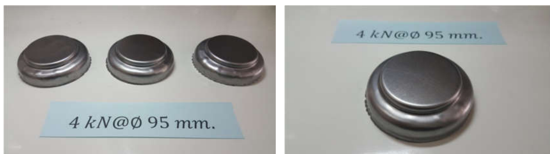
ภาพที่ 4.13(ก) แผ่นชิ้นงานเปล่า 95 มิลลิเมตร แรงจับยึด 4 kN
