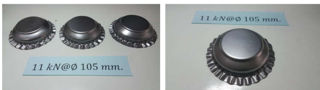
ภาพที่ 4.15(จ) แผ่นชิ้นงานเปล่า 105 มิลลิเมตร แรงจับยึด 11 kN
