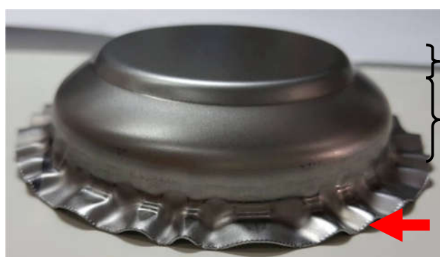
ภาพที่ 4.17(ง) ชิ้นงานที่ขนาดแผ่นขึ้นงานเปล่า 105 มิลลิเมตร แรงจับยึด 9 kN
