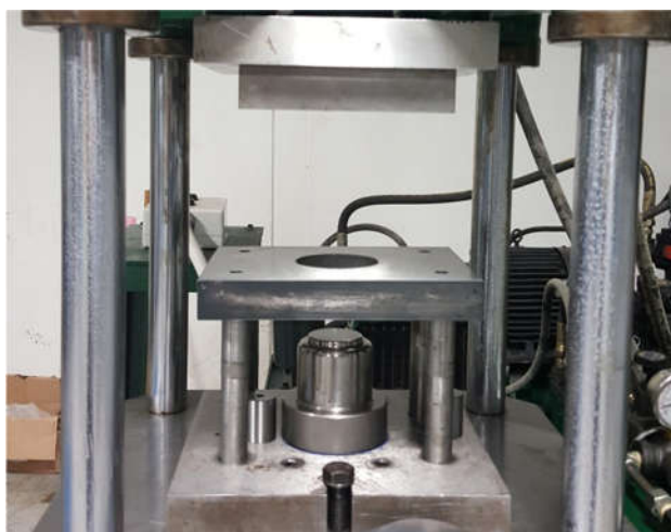
ภาพที่ 4.9 การติดตั้งชุดแม่พิมพ์กับเครื่องปั๊ม
