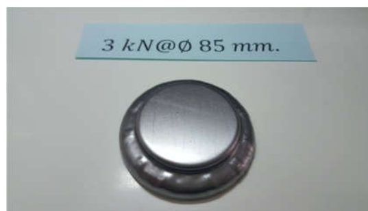
ภาพที่ 4.11(ข) แผ่นชิ้นงานเปล่า 85 มิลลิเมตร แรงจับยึด 3 kN
