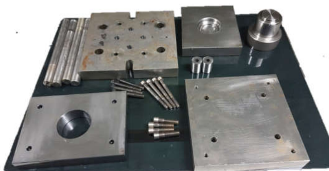
ภาพที่ 4.4 ชุดแม่พิมพ์ที่ได้จากการออกแบบ
