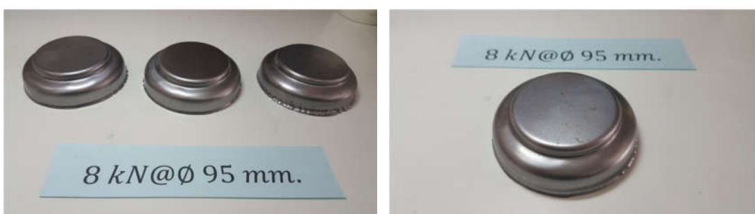
ภาพที่ 4.13(จ) แผ่นชิ้นงานเปล่า 95 มิลลิเมตร แรงจับยึด 8 kN
