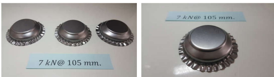
ภาพที่ 4.15(ก) แผ่นชิ้นงานเปล่า 105 มิลลิเมตร แรงจับยึด 7 kN
