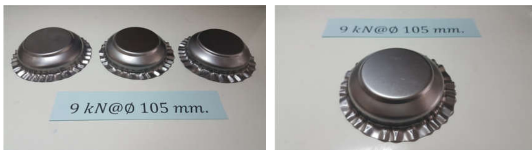
ภาพที่ 4.15(ค) แผ่นชิ้นงานเปล่า 105 มิลลิเมตร แรงจับยึด 9 kN
