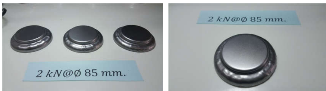
ภาพที่ 4.11(ก) แผ่นชิ้นงานเปล่า 85 มิลลิเมตร แรงจับยึด 2 kN
