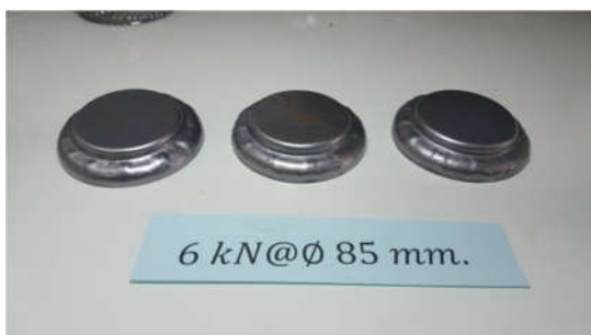
ภาพที่ 4.11(จ) แผ่นชิ้นงานเปล่า 85 มิลลิเมตร แรงจับยึด 6 kN
