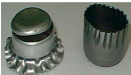
ภาพที่ 2.5 การเกิดรอยย่นของชิ้นงาน
