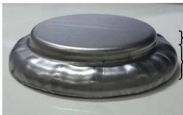
ภาพที่ 4.17(ข) ชิ้นงานที่ขนาดแผ่นขึ้นงานเปล่า 85 มิลลิเมตร แรงจับยึด 4 kN
