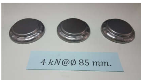
ภาพที่ 4.11(ค) แผ่นชิ้นงานเปล่า 85 มิลลิเมตร แรงจับยึด 4 kN
