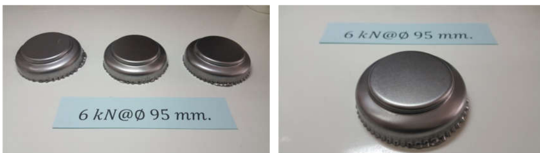
ภาพที่ 4.13(ค) แผ่นชิ้นงานเปล่า 95 มิลลิเมตร แรงจับยึด 6 kN
