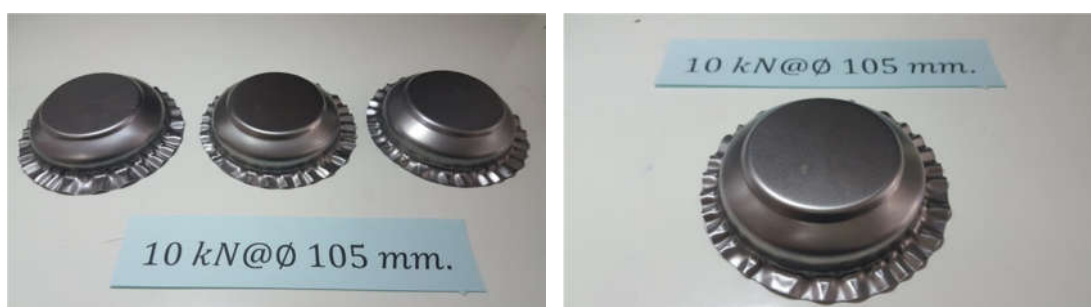
ภาพที่ 4.15(ง) แผ่นชิ้นงานเปล่า 105 มิลลิเมตร แรงจับยึด 10 kN
