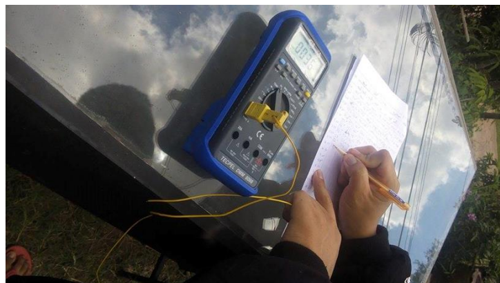
รูปที่ 3.4 การวัดและบันทึกข้อมูลอุณหภูมิอบแห้ง
