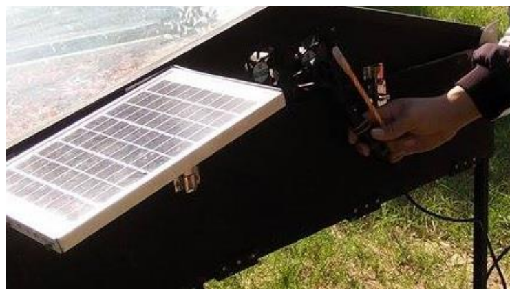
รูปที่ 3.5 การวัดความเร็วลมออกจากตู้อบแห้ง
