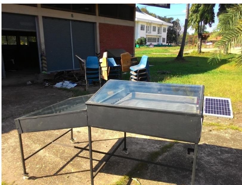
รูปที่ 4.2 ลักษณะเครื่องอบแห้งพลังงานแสงอาทิตย์ที่สร้างขึ้น
