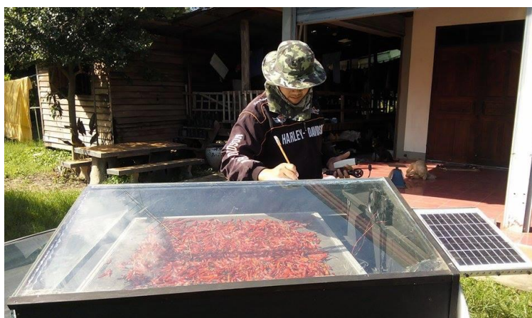
รูปที่ 3.13 วัดความเร็วลมออกจากตู้อบแห้ง
