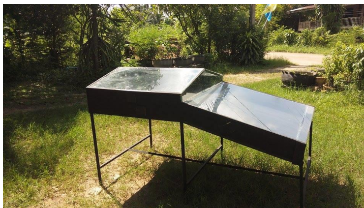
รูปที่ 3.2 เครื่องอบแห้งพลังงานแสงอาทิตย์ที่สร้างขึ้น
