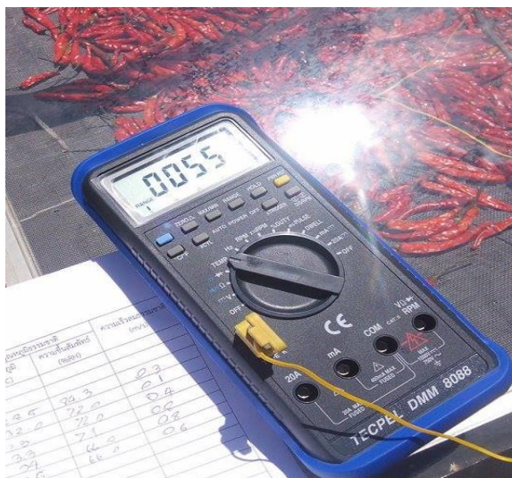
รูปที่ 3.11 การวัดอุณหภูมิภายในตู้อบแห้ง
