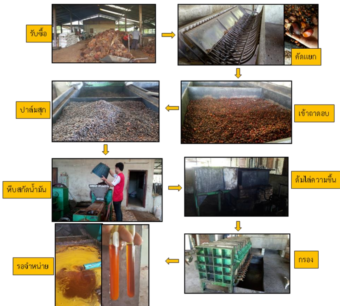
ภาพที่ 4.8 กระบวนการสกัดน้ำมันปาล์มของโรงหีบขนาดเล็กระดับครัวเรือน
