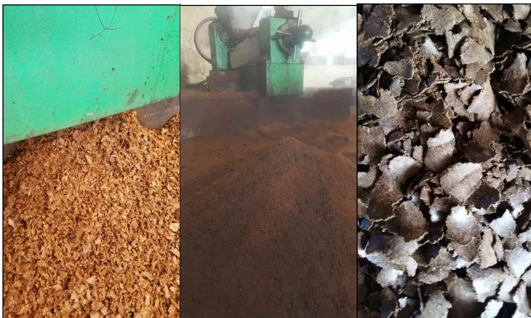
ภาพที่ 4.13 ลักษณะของกากปาล์มเป็นฝอย(ซ้าย) เป็นผง(กลาง) และเป็นแผ่น(ขวา)
