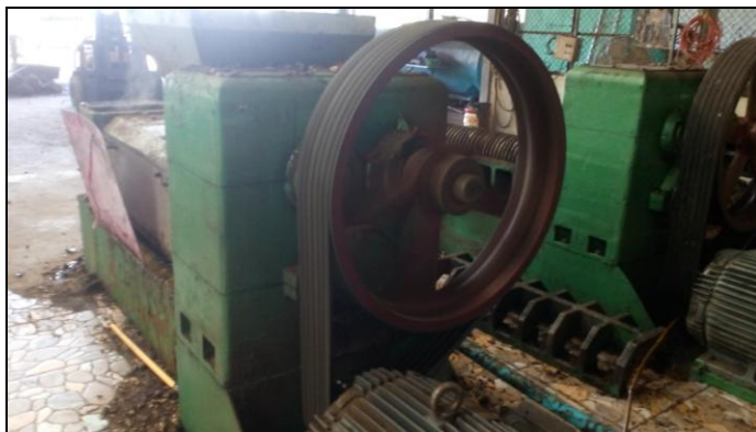
ภาพที่ 3.1 เครื่องหีบน้ำมันปาล์มระดับครัวเรือน
