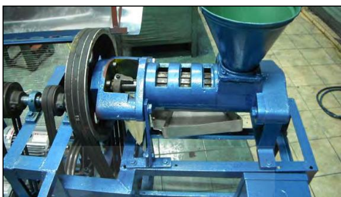
ภาพที่ 2.17 เครื่องอบและบีบน้ำมันมะพร้าวระบบบีบเย็นทำงานอย่างต่อเนื่อง
