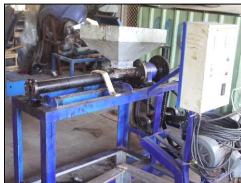
ภาพที่ 2.28 เครื่องบีบอัดน้ำมันจากเปลือกเมล็ดมะม่วงหิมพานต์แบบใช้เกลิยวอัด
