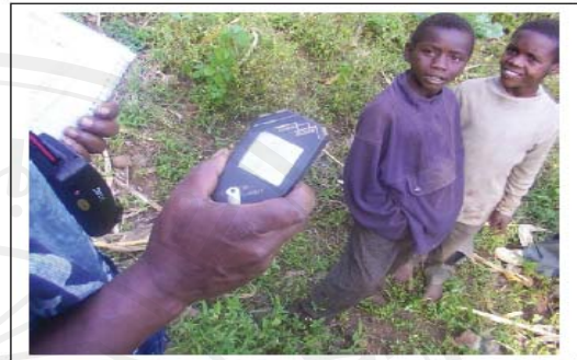
รูป 7-3 การวัดด้วย เครื่องวัดระยะสูง (altimeter) แบบดิจิตอล ที่แม่นยำ
