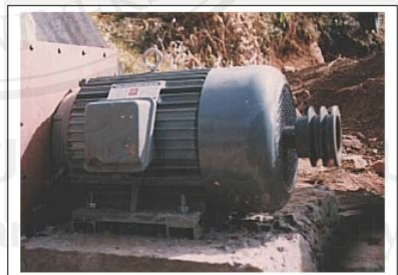
รูป 9-4 มอเตอร์เหนี่ยวนำ 3 เฟส (75 kw) 2 แกนเพลลา ใช้เป็นเครื่องกำเนิดไฟฟ้า(เนปาล)
