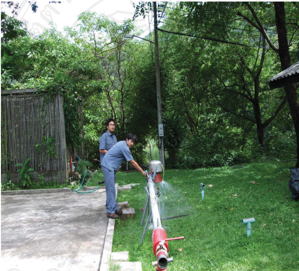
รูป ข.1 การทดสอบหาค่าที่เหมาะสมโดยใช้ DOE ผลการทดลอง Pelton Type (Multi Jet Pelton) 3 kW
