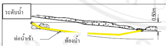
รูป 10-1 การออกแบบ ประตุน้ำเข้า(Intake) อย่างง่ายใช้ท่อเป็นเส้นทางน้ำไหล
