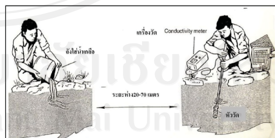
รูป 7-10 วิธีการวัดด้วยเครื่องวัด salt Galp method กระบวนการ
