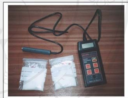
รูป 7-9 เครื่องวัดความนำไฟฟ้ามีพอด และถุงบรรจุเกลือ
