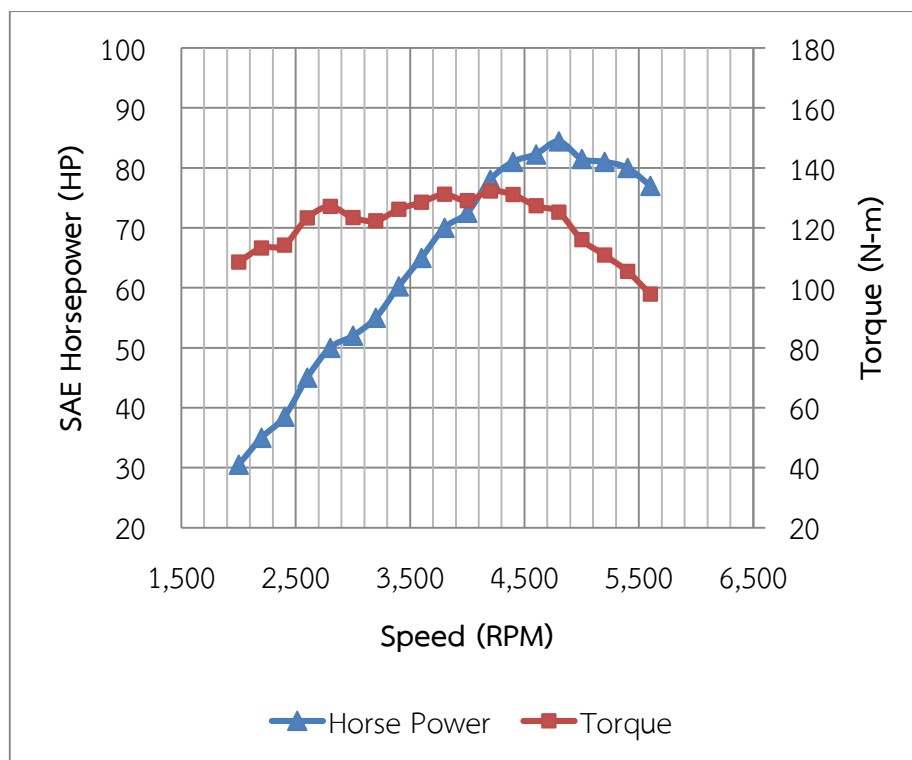
รูปที่ 4.4 กราฟแสดงผลการทดสอบทดสอบกำลังและแรงบิด แปรผันตามรอบเครื่องยนต์ โดยใช้ CBG-85 เป็นเชื้อเพลิง
