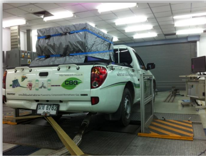
รูปที่ 3.16 การติดตั้งเครื่องมือเพื่อทำการวัดมลพิษ
