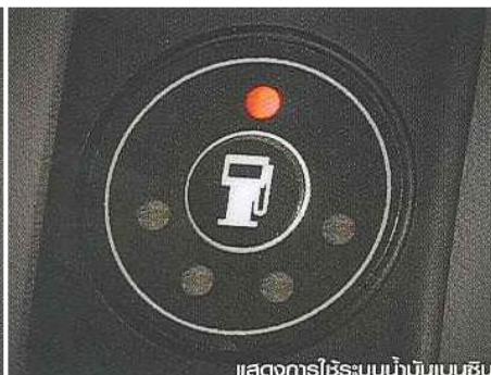
รูปที่ ค2 ไฟแสดงการใช้ระบบแก๊ส รูปที่ ค3 ไฟแสดงการใช้ระบบน้ำมันเบนซิน
