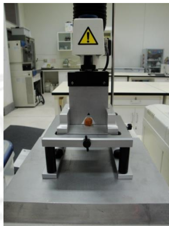
ภาพ ค-2 การวัดค่าแรงเฉือน
