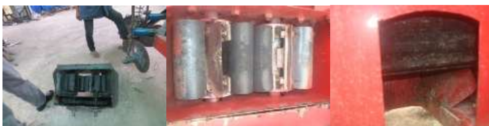
ภาพที่ 4.3 ชุดสับหรือตัดท่อน้ำมันสำปะหลัง
