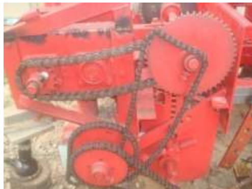
ภาพที่ 4.7 ระบบส่งกำลังแบบโซ่
