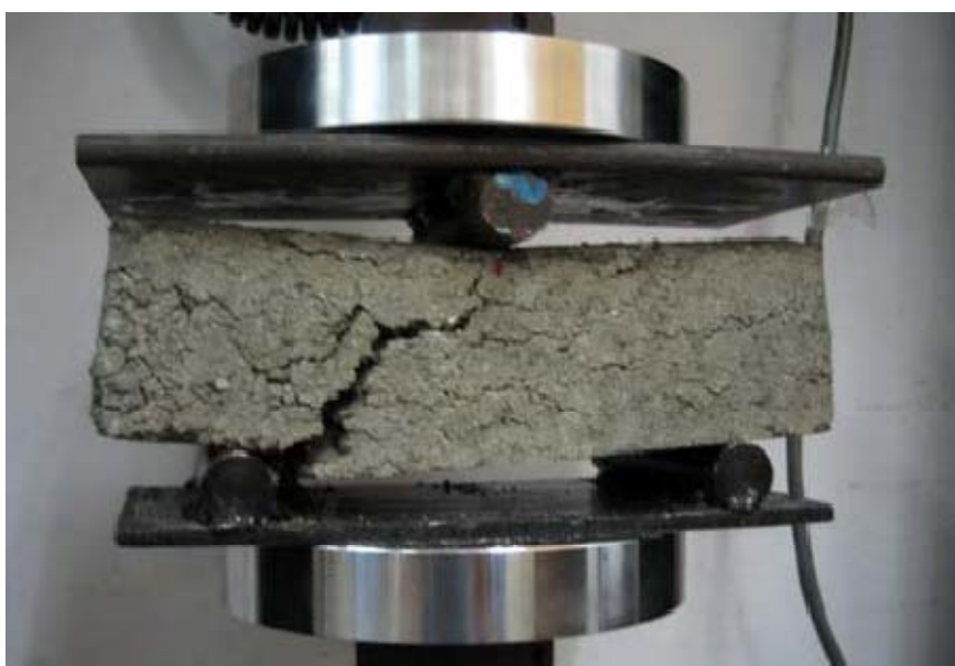
รูปที่ 12. แสดงการทดสอบหาค่ากำลังดัดของอิฐดินซีเมนต์
