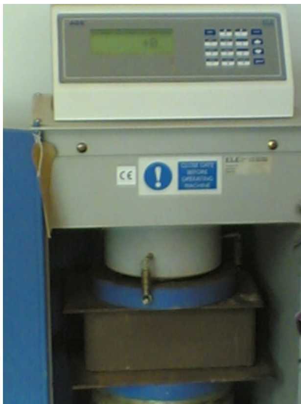
รูปที่ 11. แสดงการทดสอบหาค่ากำลังอัดของอิฐดินซีเมนต์
