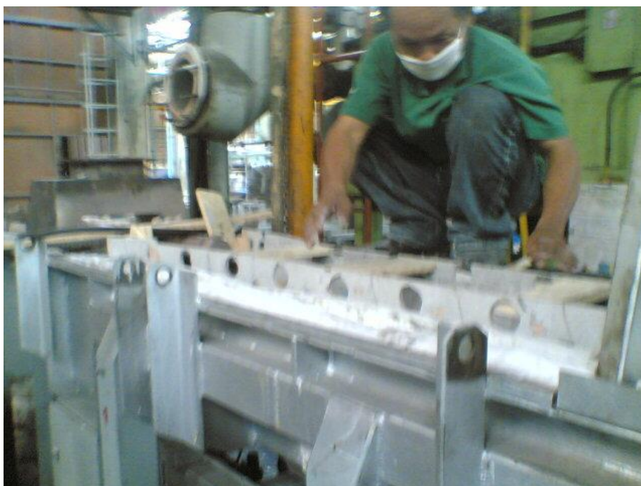
รูปภาคผนวกที่ 12. แสดงการหล่อของชิ้นส่วนรางกระแทกความร้อนของ silica refractory แบบ casting type (2)
