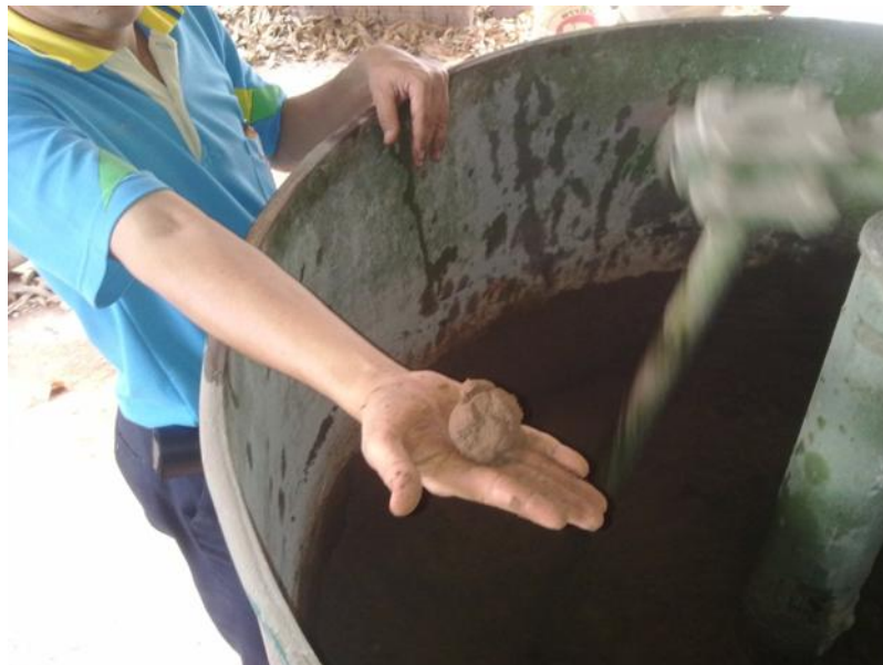
รูปที่ 2. สาธิตวิธีการทดสอบ ball in hand test
