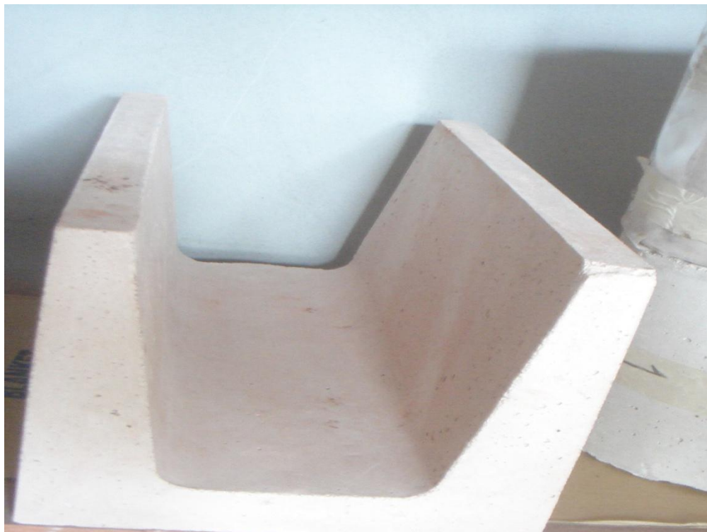
รูปภาคผนวกที่ 15. แสดงการหล่อของชิ้นส่วนสำเร็จรูปของรางกระแทกความร้อนของ silica refractory แบบ casting type (3)
