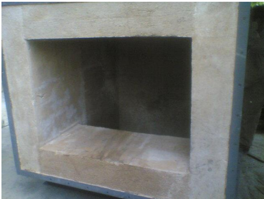
รูปภาคผนวกที่ 5. แสดงการหล่อโมดูลของชิ้นส่วนปล่องควันกระทบความร้อนของ silica refractory แบบ casting type(1)
