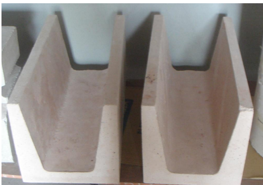
รูปภาคผนวกที่ 14. แสดงการหล่อของชิ้นส่วนสำเร็จรูปของรางกระแทกความร้อนของ silica refractory แบบ casting type (1)
