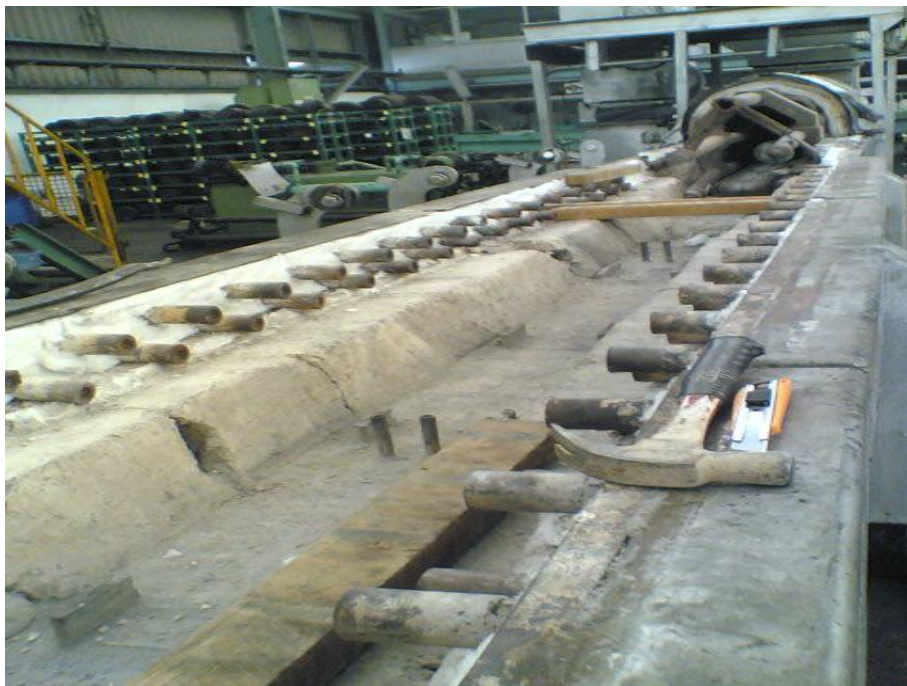
รูปภาคผนวกที่ 11. แสดงการหล่อของชิ้นส่วนรางกระแทกความร้อนของ silica refractory แบบ casting type (1)
