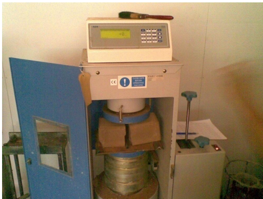
รูปที่ 9. แสดงการทดสอบหาค่ากำลังอัดของอิฐดินซีเมนต์
