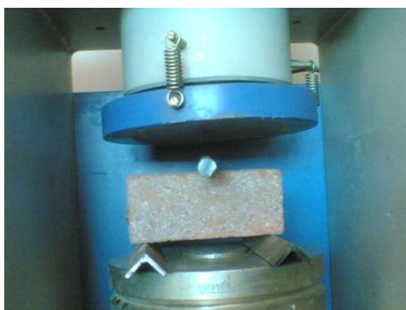
รูปที่ 10. แสดงการทดสอบหาค่ากำลังดัดของอิฐดินซีเมนต์
