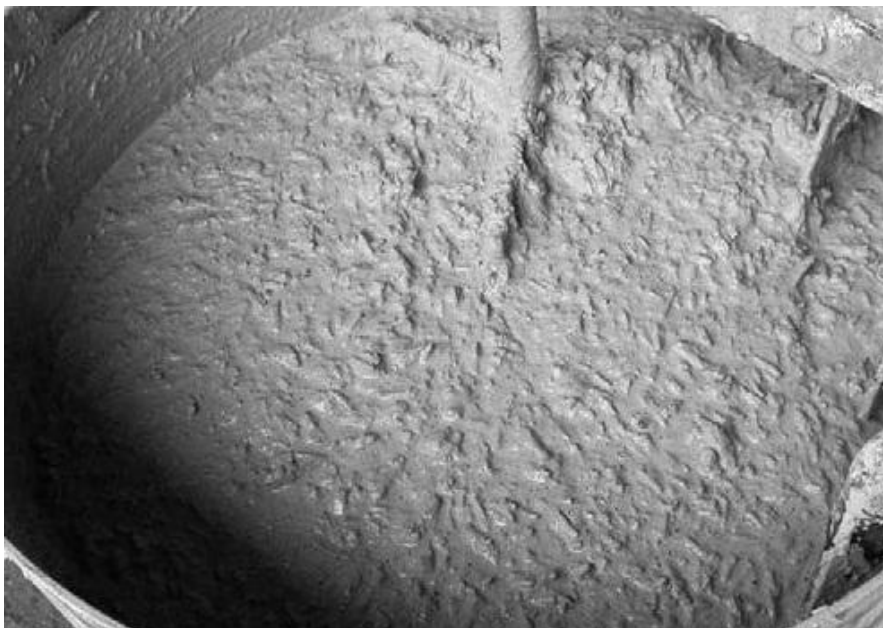
รูปที่ 8. แสดงการผสมเศษเส้นมยเซลลูโลสกับดินท้องถิ่นและปูนซีเมนต์ปอร์ตแลนด์
