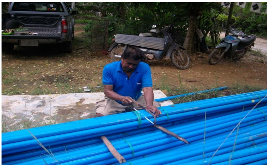
ภาพที่ 6.15 การเตรียมท่อพีวีซีสำหรับจัดทำบ้านปลา
