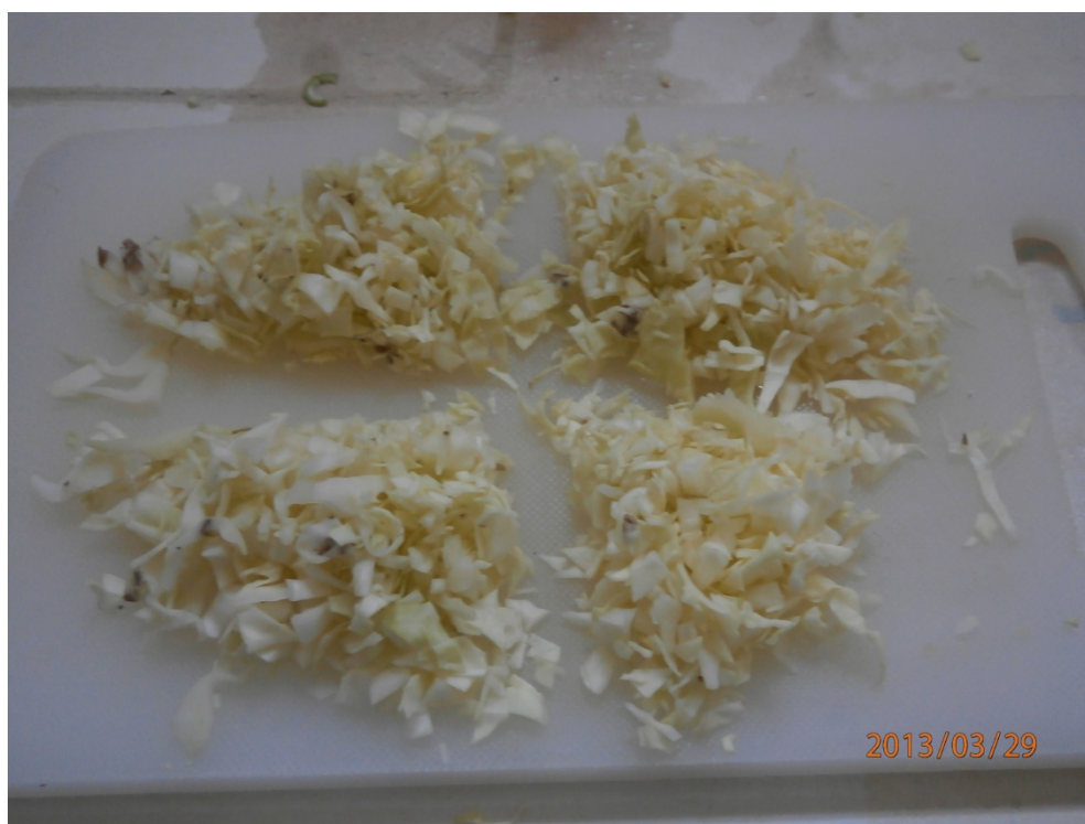
การสับตัวอย่างด้วยวิธี Quartering
