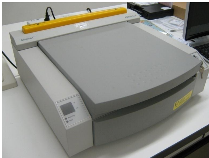
รูปที่ 3.9 เครื่อง XRF spectrometer
