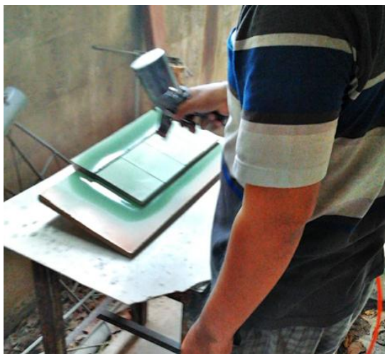
รูปที่ 3.16 ฟันผงสีผสมเคลือบลงบนแผ่นหลังคา
