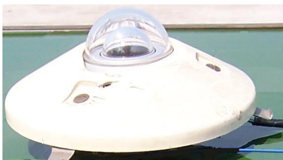
รูปที่ 3.21 pyranometer ใช้วัดความเข้มรังสีอาทิตย์
