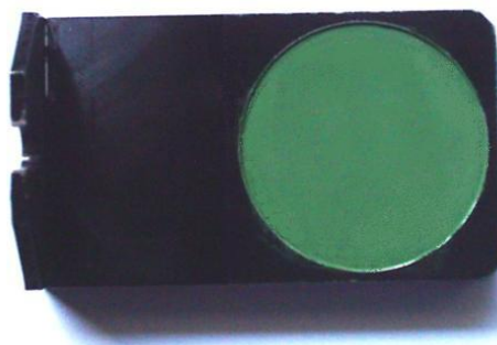
รูปที่ 3.6 ตัวอย่างเม็ดสีอัดในอุปกรณ์เพื่อวัดค่าสะท้อน
