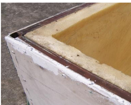
รูปที่ 3.19 ห้องทดสอบด้านในบุด้วยโฟมพอลิยูรีเทนความหนา 5 เซนติเมตร
