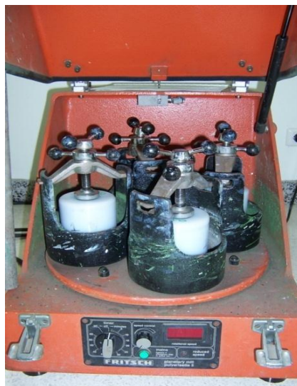
รูปที่ 3.3 หม้อบดความเร็วสูงชนิด agate
