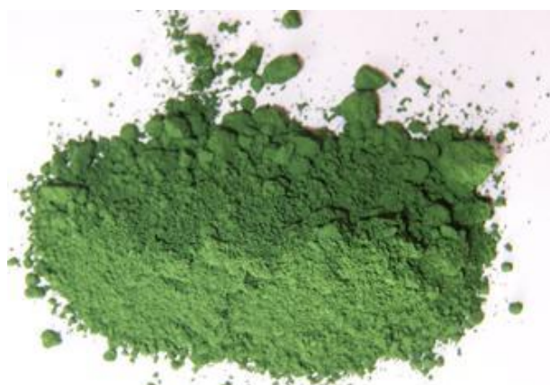
รูปที่ 3.5 ตัวอย่างเม็ดสีเขียวอ่อนที่มีสมบัติสะท้อนอินฟราเรดใกล้
