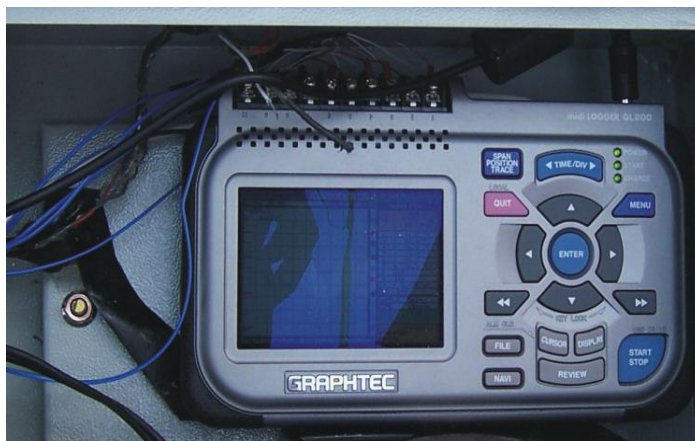
รูปที่ 3.20 datalogger ใช้บันทึกอุณหภูมิ
