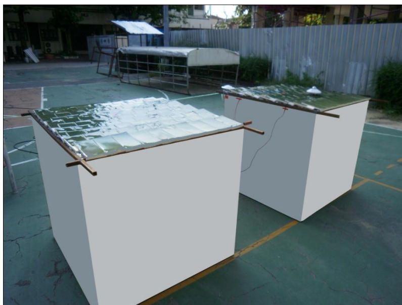
รูปที่ 3.22 ห้องทดสอบกลางแจ้งติดตั้งอุปกรณ์วัดอุณหภูมิและบันทึกข้อมูล
