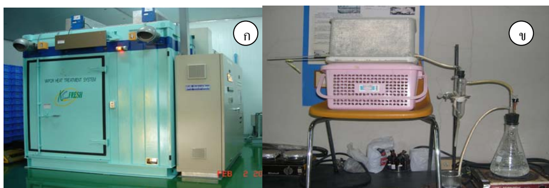
ภาพที่ 6 การอบไอน้ำมะม่วงด้วยห้องอบ VHT ของโรงงานส่งออก (ก) และชุดจำลอง VHT (ข)
