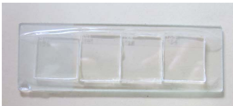
ภาพที่ 3.6 แผ่น CR-39 ที่ผ่านกระบวนการกักขायรอยรังสีแอลฟาติดบนแผ่นสไลด์
