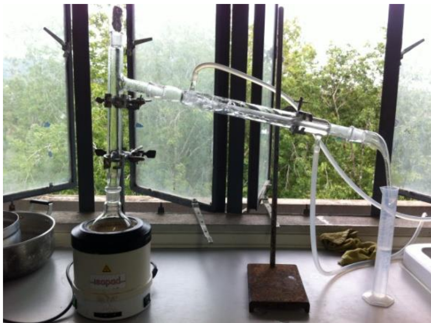
ภาพ จ-8 แสดงการกลั่นแอลกอฮอล์เพื่อปรับ ปริมาณแอลกอฮอล์ให้ได้ร้อยละ 10 เพื่อเข้าสู่กระบวนการหมักน้ำส้มสายชูหมัก
