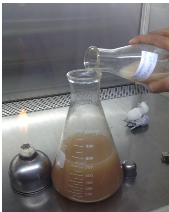
ภาพ จ-11 แสดงการเติม Stater Saccharomyces cerevisiae ในปริมาณร้อยละ 7 ลงในน้ำล่องกองในขั้นตอนการหมักเพื่อให้ได้แอลกอฮอล์
