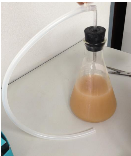
ภาพ จ-12 แสดงการหมักไวน์ในฟลาสก์ ในสภาพที่ไม่ใช้อากาศปิดปากขวดที่ทำด้วยจุกยางเจาะรูฝาขวดแล้วต่อสายยางลงในถังพลาสติกที่มีน้ำบรรจุเพื่อไม่ให้อากาศเข้าสู่ถึงหมัก
