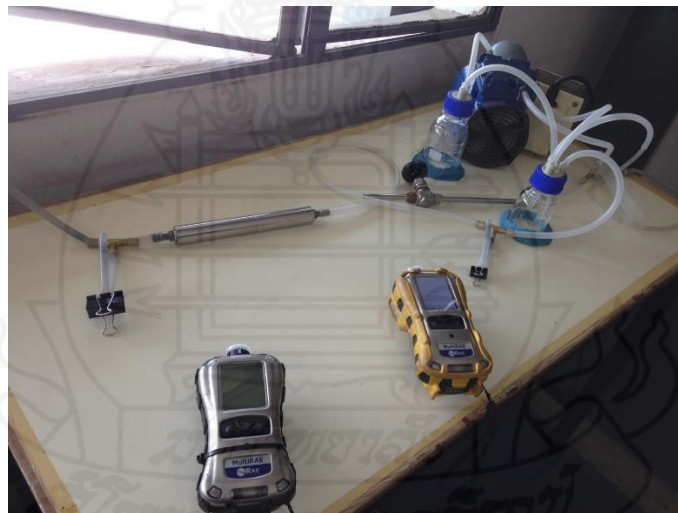
ภาพที่ 3.17 การทดสอบการดูดซับไอระเหยสารโพลีอิน
