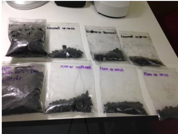
ภาพที่ 3.8 ตัวอย่างถ่านกัมมันต์ที่นำไปส่องด้วยกล้องจุลทรรศน์อิเล็กตรอน
