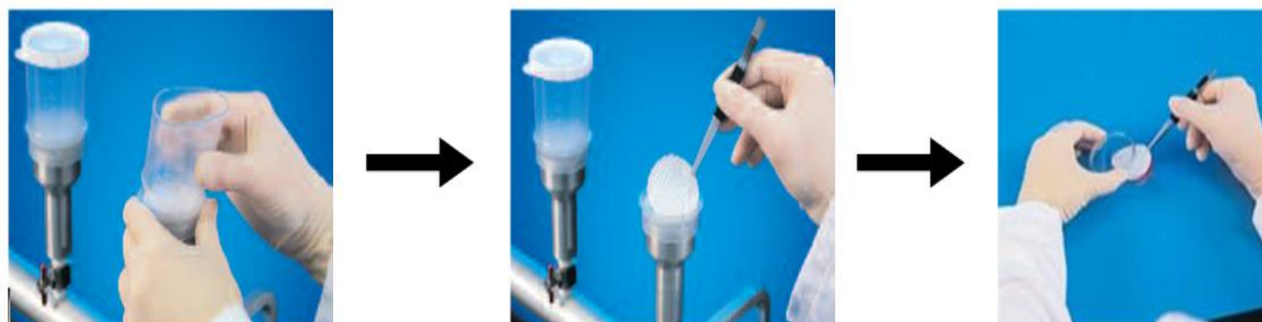
รูปที่ 6 แสดงการใช้ forceps คีบเมมเบรนเปล่าวางบนจานเพาะเชื้อ sterile PCA
