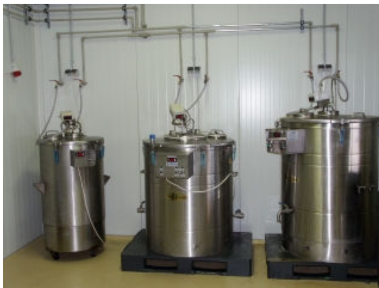
ภาพที่ 4 ถังหมักน้ำส้มสายชูแบบ submerged method ที่มา: http://mb01vinegar.angelfire.com/processdescript.html
