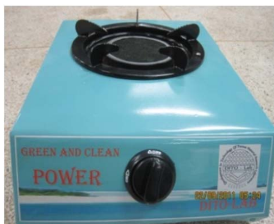
(ค) เตาแก๊สแบบวัสดุพูนชนิดโลหะเซลล์อาร์เปิด
