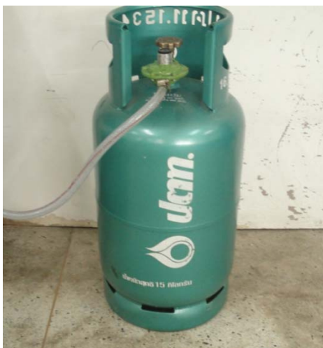
ภาพที่ ก.2 ถังแก๊สและหัวปรับความดัน (pressure regulator)
