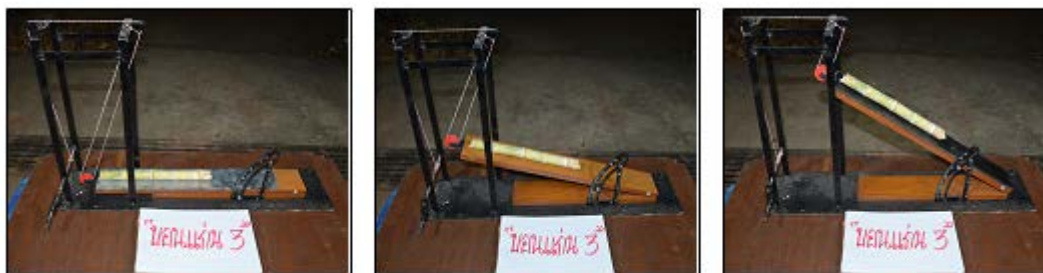
รูปที่ 3.3 การวัดมุมเสียดทานการลื่นไถลของท่อนพันธุ์อ้อย
