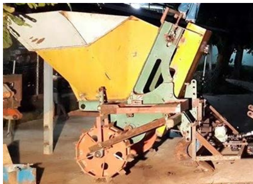
รูปที่ 3.2 3 การติดตั้งชุด Gear Box เข้ากับเครื่องปลูกอ้อยแบบท่อนพันธุ์
