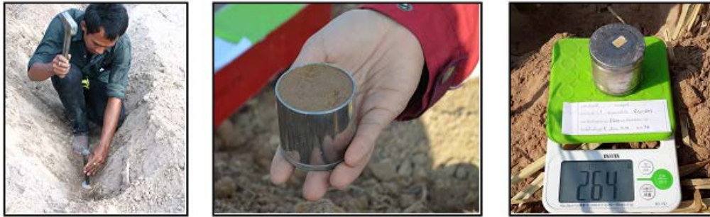
รูปที่ 3. 28 การเก็บข้อมูลตัวอย่างดินภายในแปลงทดสอบ โดยใช้กระบอกลบตัวอย่างดิน
