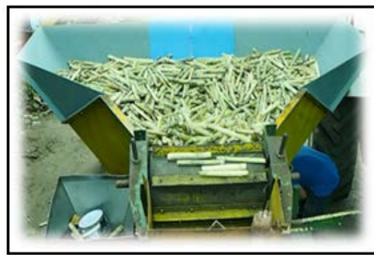
รูปที่ 4.7 รูปแบบมุมเอียงของถังบรรจุท่อนพันธุ์ก่อนการปรับปรุง และรูปแบบมุมเอียงของถังบรรจุท่อนพันธุ์หลังการปรับปรุง
