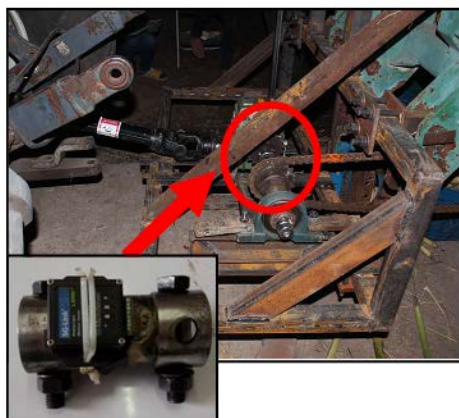
รูปที่ 3. 24 การติดตั้งชุดเครื่องมือวัดค่าแรงบิด
