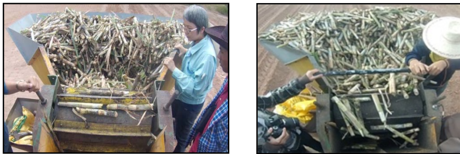
รูปที่ 4.19 รูปแบบชุดใบสะพานลำเลียงก่อนการพัฒนา และหลังการพัฒนา แบบที่ 2 ตามลำดับ
