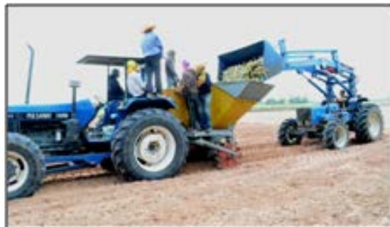
รูปที่ 3.2 1 การขนถ่ายท่อนพันธุ์อ้อยใส่ลงในถังบรรจุท่อนพันธุ์ของเครื่องปลูกอ้อยแบบท่อนพันธุ์
