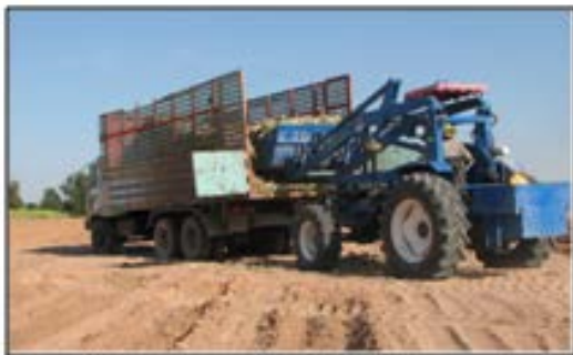
รูปที่ 3.2 1 การขนถ่ายท่อนพันธุ์อ้อยใส่ลงในถังบรรจุท่อนพันธุ์ของเครื่องปลูกอ้อยแบบท่อนพันธุ์
