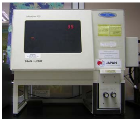
ภาพที่ 10 เครื่อง Near Infrared Spectroscopy รุ่น InfraAlyzer 500 ของ Bran+Luebbe และ รุ่น FQA-NIR GUN ของ FANTEC ตามลำดับ
