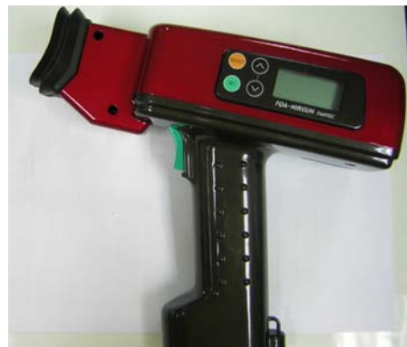
ภาพที่ 10 เครื่อง Near Infrared Spectroscopy รุ่น InfraAlyzer 500 ของ Bran+Luebbe และ รุ่น FQA-NIR GUN ของ FANTEC ตามลำดับ
