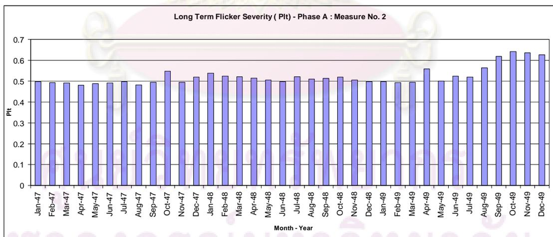
รูปที่ 6.10 กราฟแท่งแสดงข้อมูล CP95 ของ Plt เฟส A ของเครื่องวัดหมายเลข 2
