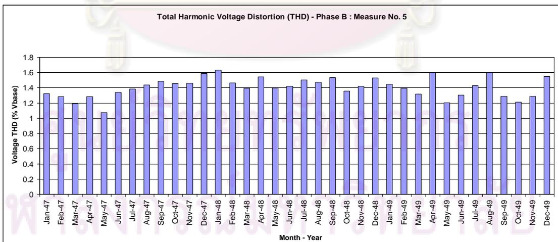
รูปที่ 6.66 กราฟแท่งแสดงข้อมูล CP95 ของ THDV เฟส B ของเครื่องวัดหมายเลข 5
