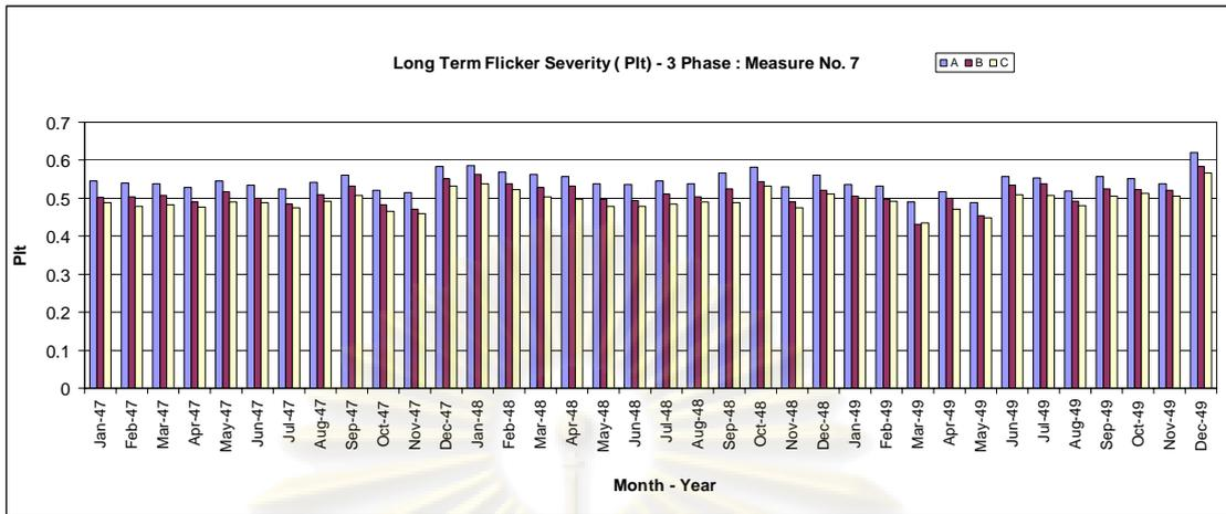
รูปที่ 6.98 กราฟแท่งแสดงข้อมูล CP95 ของ Pit ทั้ง 3 เฟส ของเครื่องวัดหมายเลข 7
