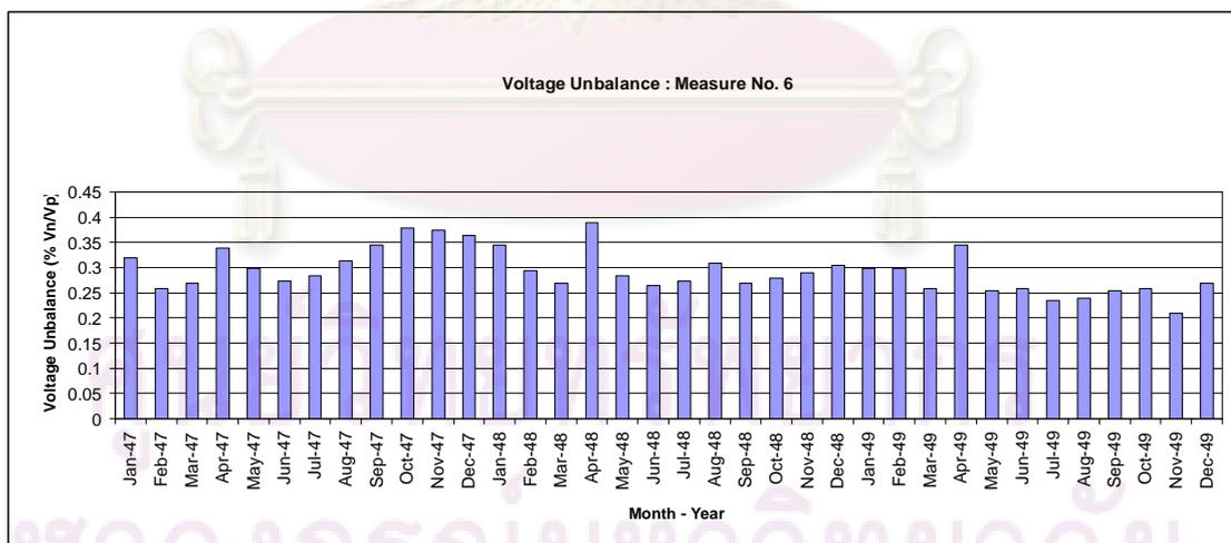
รูปที่ 6.77 กราฟแท่งแสดงข้อมูล CP95 ของแรงดัน ไม่สมดุล ของเครื่องวัดหมายเลข 6
