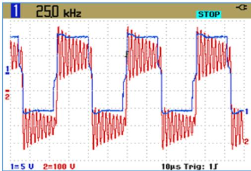
รูปที่ 6 รูปคลื่นสัญญาณอัลตราโซนิกความถี่ 25 กิโลเฮิร์ตซ์ ขณะไม่ต่อโหลด
