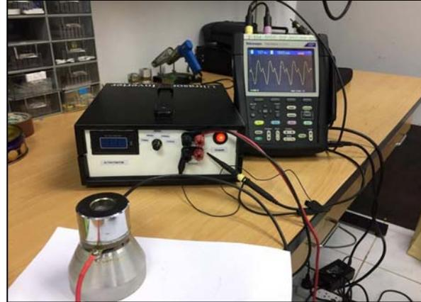
รูปที่ 5 เครื่องมือวัดทดสอบรูปคลื่นสัญญาณอัลตราโซนิก
