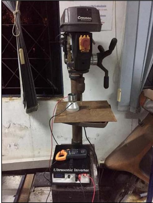
รูปที่ 12 ทดสอบเจาะแผ่นวัสดุตัวอย่าง และบันทึกผลการวัด
