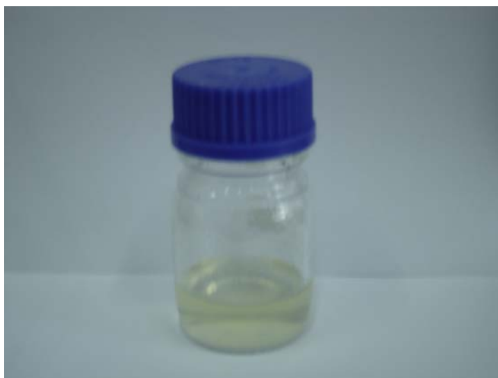
ภาพผนวกที่ ก3 ผลลัพธ์ของเหลวที่ได้จากการแตกโมเลกุลพลาสติกพอลิพรอพิลีนโดยใช้ความร้อนเพียงอย่างเดียว
