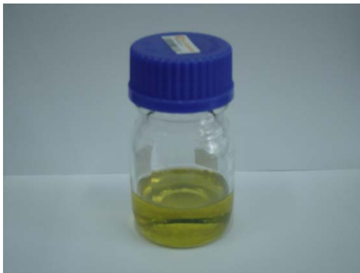
ภาพผนวกที่ ก4 ผลลัพธ์ของเหลวที่ได้จากการแตกโมเลกุลพลาสติกพอลิพรอพิลีนโดยใช้ตัวเร่งปฏิกิริยา E-cat
