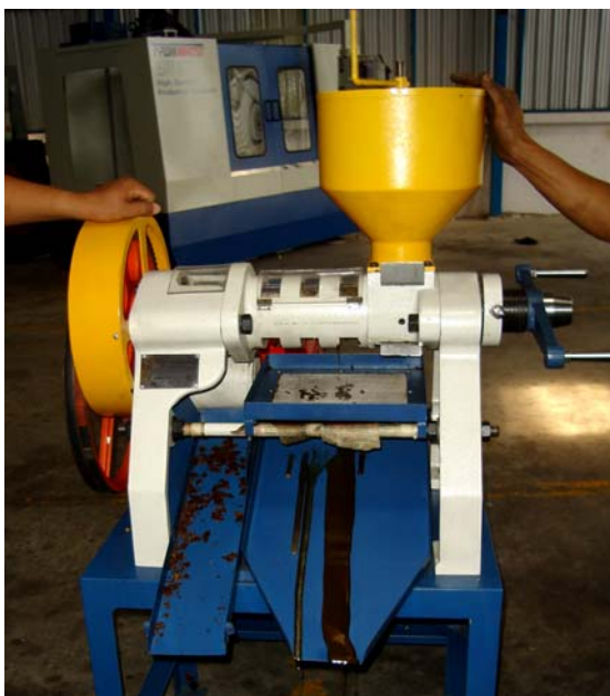
ภาพผนวกที่ ก2 การสกัดน้ำมันสบูดำด้วยเครื่องสกัดแบบเกลียว (Screw press)
