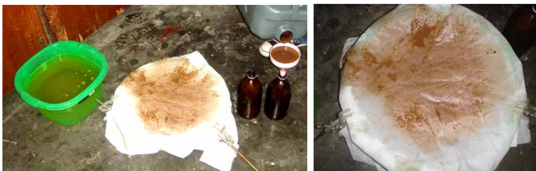
ภาพผนวกที่ ก3 การกรองตะกอนหยาบของน้ำมันสบูดำด้วยผ้าขาวบาง
