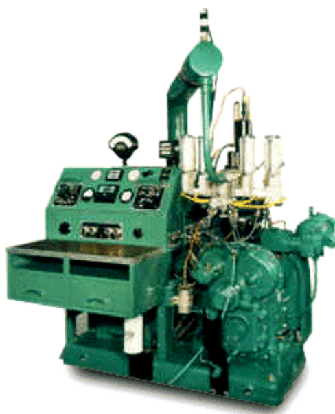
ภาพที่ 2 เครื่องยนต์มาตรฐานที่ใช้ในการทดสอบความต้านทานการน็อก (CFR Engine)
