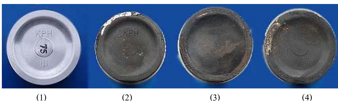
ภาพที่ 58 ลักษณะพื้นผิวหน้าลูกสูบหลังการทดสอบกับเครื่องยนต์หัวฉีด เมื่อใช้น้ำมันตัวอย่างชนิดต่าง ๆ คือ ลูกสูบไม่ผ่านการใช้งาน (1) น้ำมันเบนซิน 91 (2) น้ำมันผสมเบนซิน-สบูดำ 5% (3) และ น้ำมันผสมเบนซิน-สบูดำ 10% (4)
