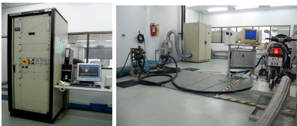
ภาพที่ 35 แสดงระบบวิเคราะห์ข้อมูล (ซ้าย) และระบบการทดสอบสมรรถนะและมลพิษ (ขวา)
