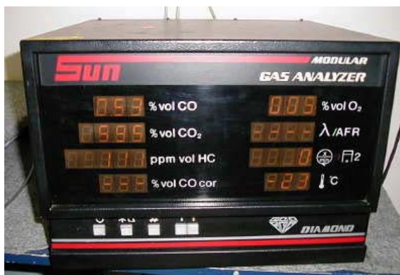
ภาพที่ 41 เครื่องวัดปริมาณก๊าซไอเสีย (Gas Analyzer) ยี่ห้อ Sun รุ่น MGA1200
