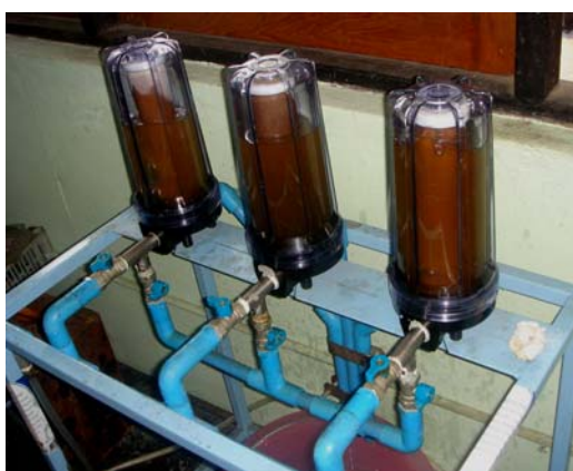
ภาพผนวกที่ 5 การกรองน้ำมันสบูดำด้วยเครื่องกรองตะกอนละเอียดขนาด 3 ไมครอน
