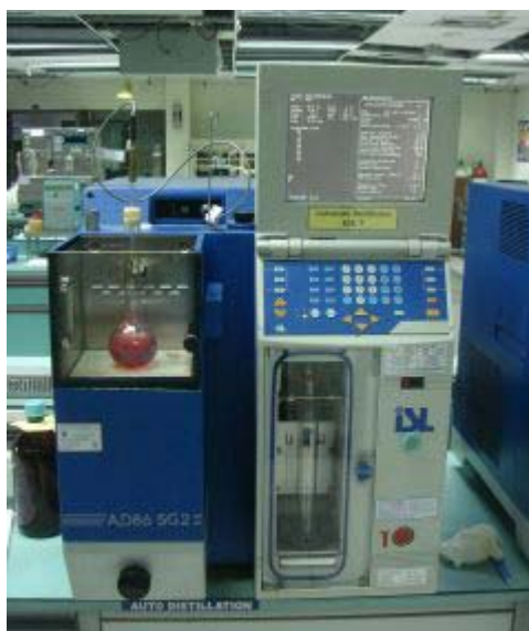
ภาพที่ 32 เครื่องทดสอบค่าการกลั่น (Automatic Distillation) ยี่ห้อ ISL รุ่น AD86 5G2
