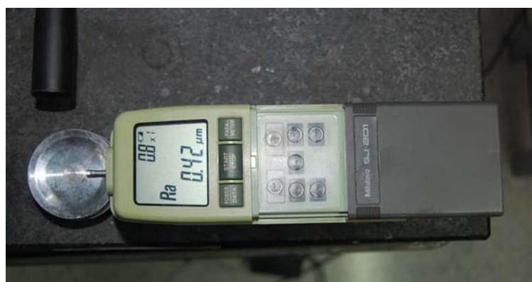
ภาพที่ 45 แสดงการวัดค่าความขรุขระของพื้นผิวด้วยเครื่อง Surface Roughness Tester
