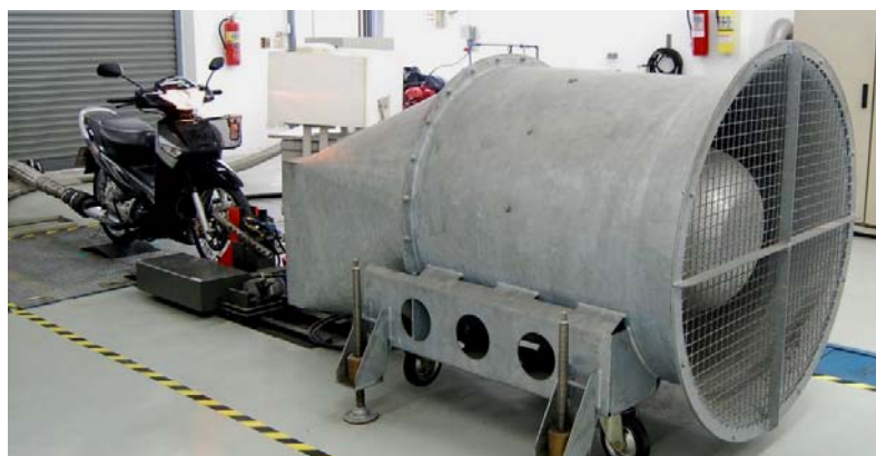
ภาพที่ 33 ภาพแสดงไดนาโมมิเตอร์ที่ใช้ในการทดสอบ (Chassis Dynamometer) ยี่ห้อ Schenck
