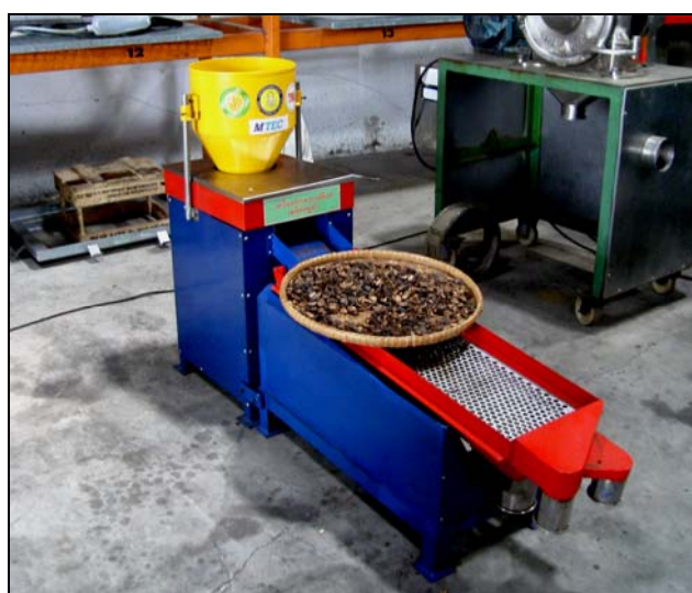
ภาพผนวกที่ ก1 การบดเมล็ดสบู่ดำด้วยเครื่องกระเทาะเปลือกเมล็ดสบู่ดำ
