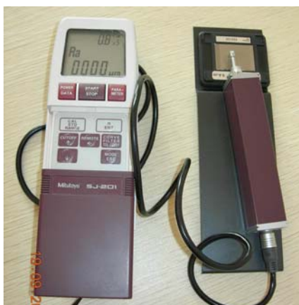
ภาพที่ 39 เครื่องมือวัดความขรุขระของผิวหน้าสัมผัส ยี่ห้อ Mitutoyo รุ่น SJ-201
