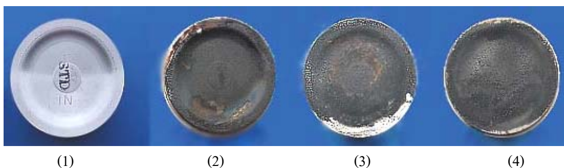
ภาพที่ 57 ลักษณะพื้นผิวหน้าลูกสูบหลังการทดสอบกับเครื่องยนต์คาร์บูเรเตอร์ เมื่อใช้น้ำมันตัวอย่างชนิดต่าง ๆ คือ ลูกสูบไม่ผ่านการใช้งาน (1) น้ำมันเบนซิน 91 (2) น้ำมันผสมเบนซิน-สบูดำ 5% (3) และ น้ำมันผสมเบนซิน-สบูดำ 10% (4)
