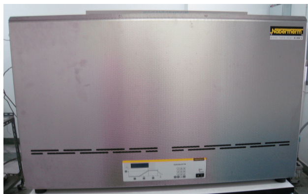
ภาพที่ 11 เตาเผาพิสัยอุณหภูมิ 30-3000°C ผลิตโดยบริษัท Nabertherm
