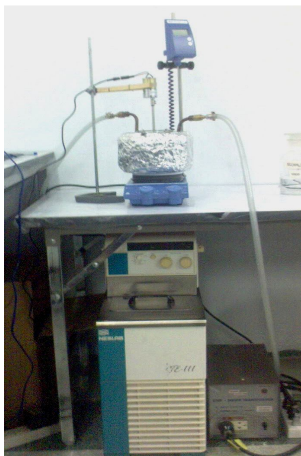
ภาพที่ ๑ แสดงการจัดเรียงอุปกรณ์ที่ใช้ในการเตรียมฟิล์ม CdS/CdTe โดยวิธีออบสารละลายเคมี
