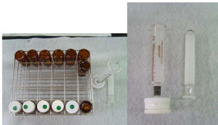
Figure B.11. Filter Instrument Set
