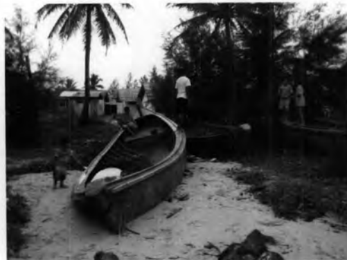
เรือที่ทำจากไฟเบอร์ที่ได้รับแจกซึ่งไม่ทนทานเหมือนเรือที่ทำจากไม้ ดังนั้นชาวประมงจึงไม่นิยมใช้ออกทะเล
