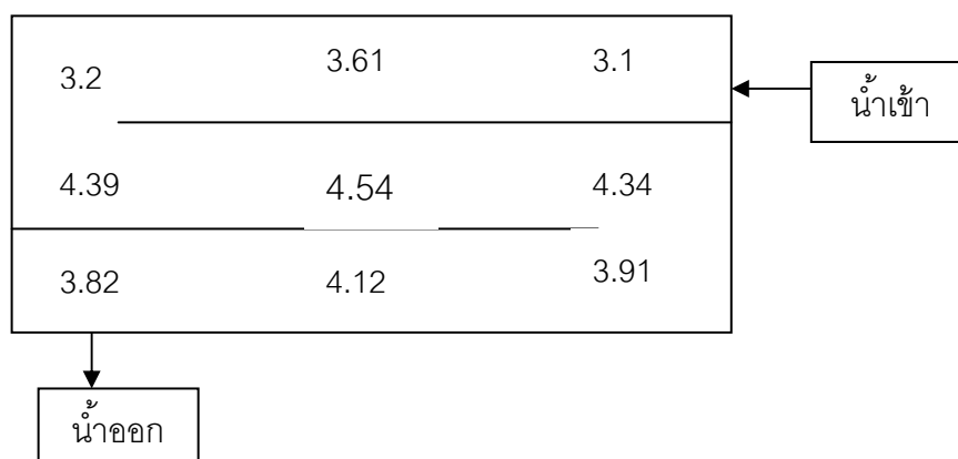
ภาพที่ 3.5 ความเข้มแสงอัลตราไวโอเล็ตเอ (มิลลิวัตต์ต่อตารางเซนติเมตร) ที่จุดต่างๆ ในการทดลองแบบไหลต่อเนื่อง
